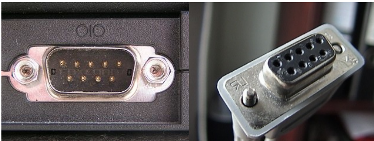
Photos extraites du site Wikipédia - Connecteur DB9 Mâle à gauche ; Femelle à droite
