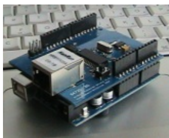
Figure 2 : Une carte Arduino étendue avec un Ethernet Shield
