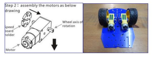
Une fois le moteur positionné sur le châssis entre les deux supports, on peut visser l'ensemble avec les vis M3\*30, deux vis par support. Attention, les vis sont un peu difficiles à insérer.
